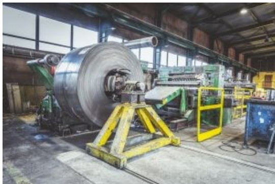
Поздовжній розкрій рулонів і смуг на стрічки з обрізанням крайок
