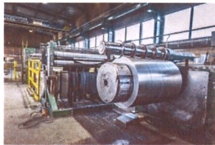
Поздовжня лінія — намотування розкромлених стрічок
