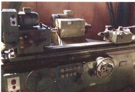
Кругле шліфування дискових ножів і валків
